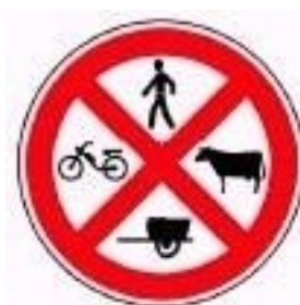
Trânsito proibido a peões, a animais e a veículos que não sejam automóveis ou motociclos
